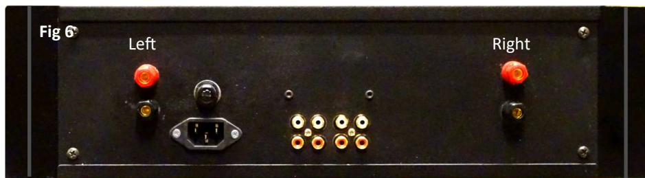
Fig 6 Vista da retro. Al centro i quattro ingressi linea, alle estremità i morsetti di uscita per gli altoparlanti e sulla sinistra la vaschetta di alimentazione ed il fusibile di protezione degli alimentatori.
