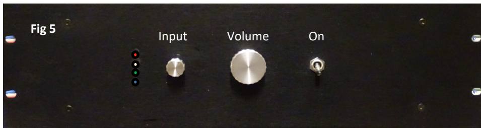
Fig 5 Vista frontale dell'apparecchio. Al centro la manopola di controllo del volume, a destra l'interruttore di accensione e a sinistra il selettore degli ingressi con i quattro LED indicatori.
