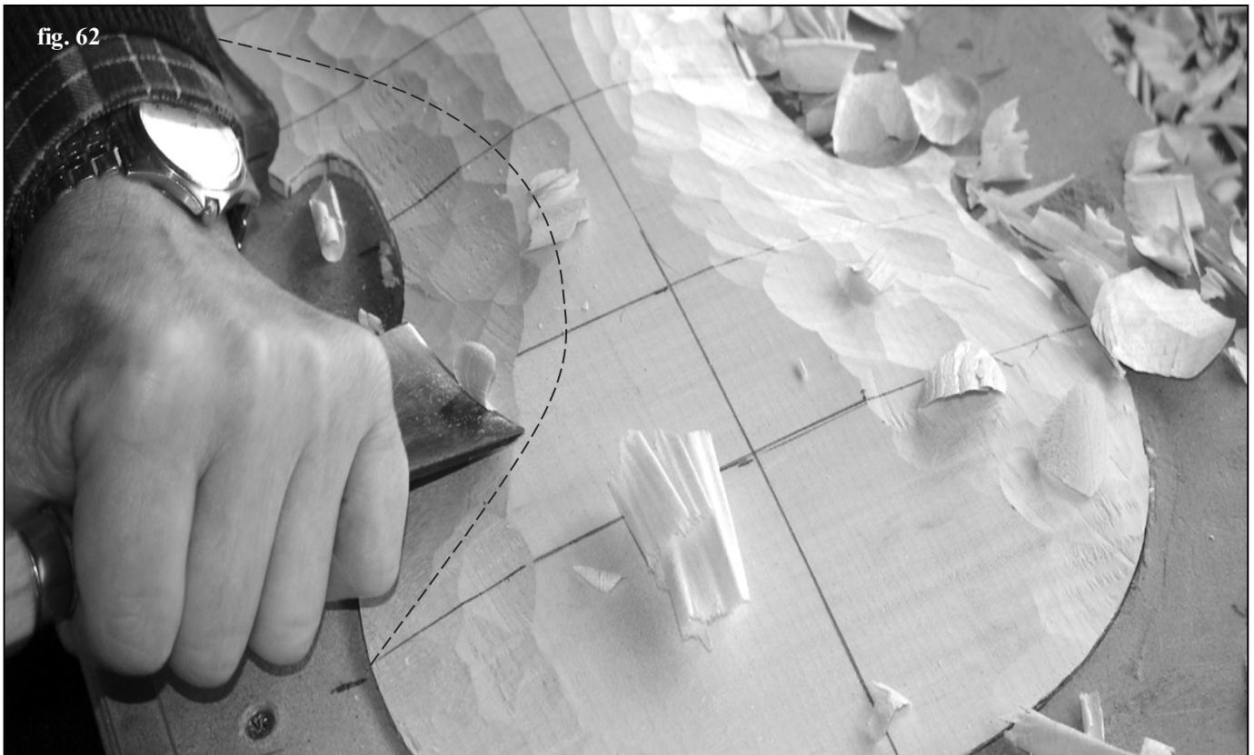
Con una sgorbia sufficientemente grande rimuovere il legno in queste zone come appare nell'immagine di **fig. 62**. Fare molta attenzione a non eccedere nella rimozione del legno in particolare nel bordo esterno, già segnato, e che deve mantenere lo spessore di 4 mm su tutto il suo perimetro.
