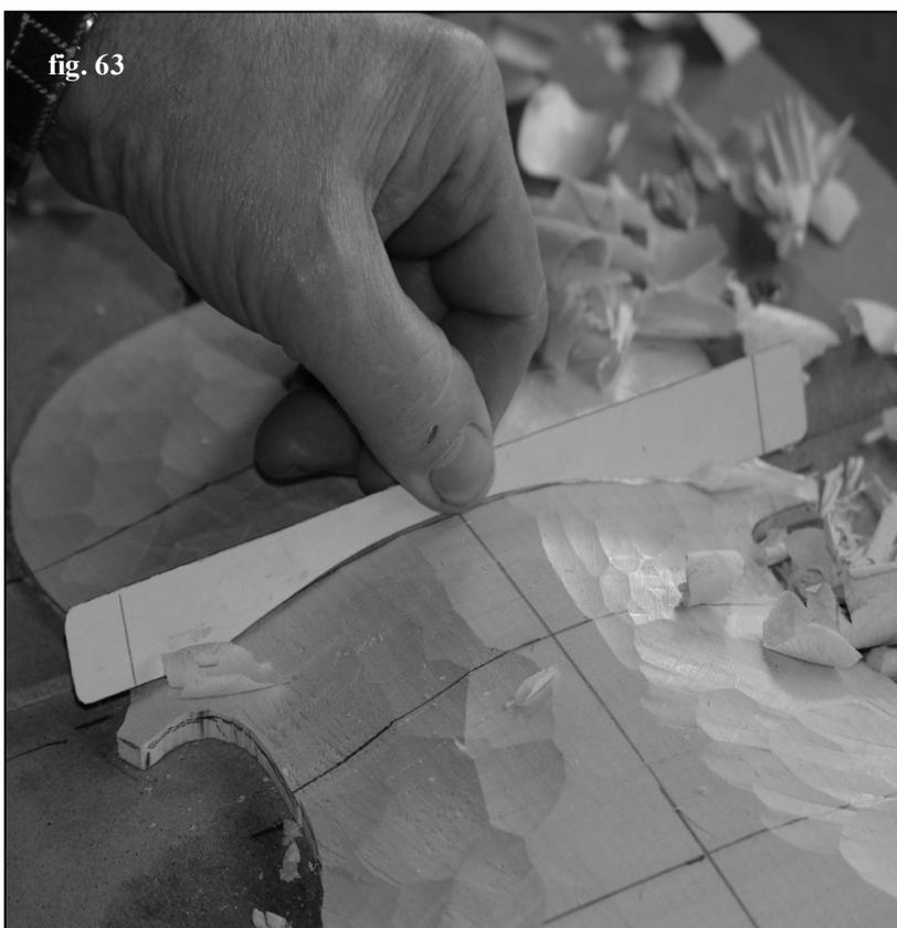
Controllare ripetutamente, con l'uso delle relative dime, le curvature della tavola che via via prendono forma, sia nel senso trasversale che longitudinale come mostrato nelle **fig. 63** e **66**.
