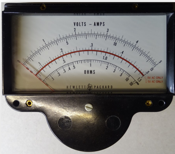
Indicatore Analogico HP ma con scala diversa dal modello HP 410B
