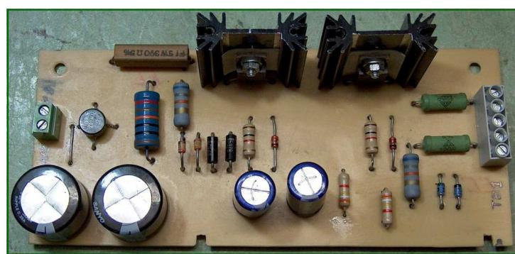
**FIG. 4** Alimentatore alta tensione (260V)
