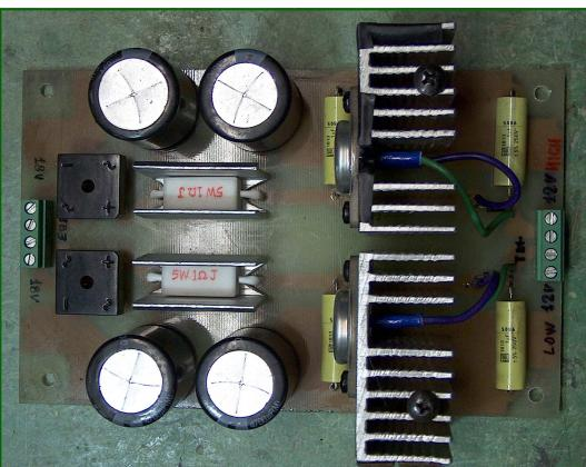
**FIG: 3** Alimentatore per filamenti in cc
