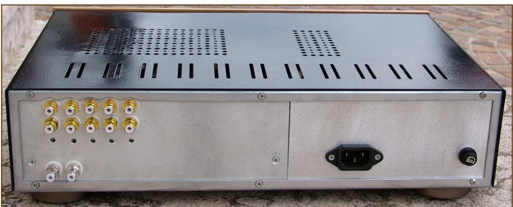
Vista posteriore con gli ingressi e, sotto i fori di accesso ai potenziometri di livello.
