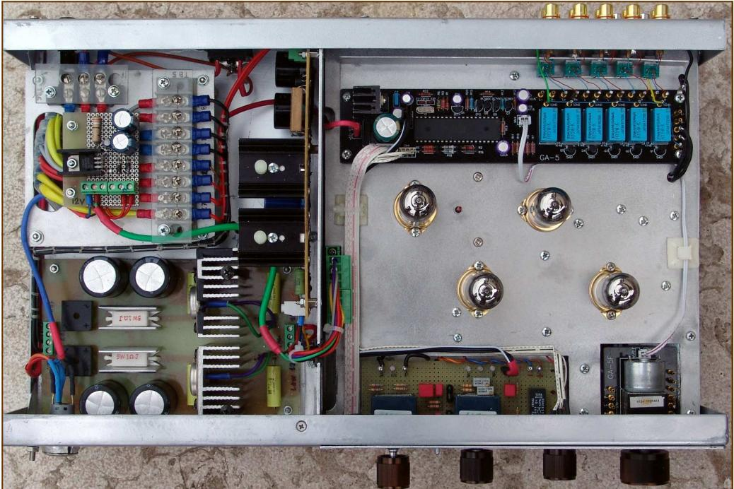
Vista superiore. A sinistra l'alimentazione e a destra i tubi elettronici e il circuito selettore degli ingressi.
