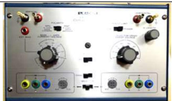
Traccia-curve per transistor Funzionante
