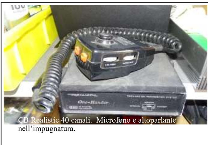
CB Realistic 40 canali. Microfono e altoparlante nell'impugnatura.
