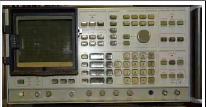
Analizzatore di Spettro HP 3585A 20Hz—40 MHz
