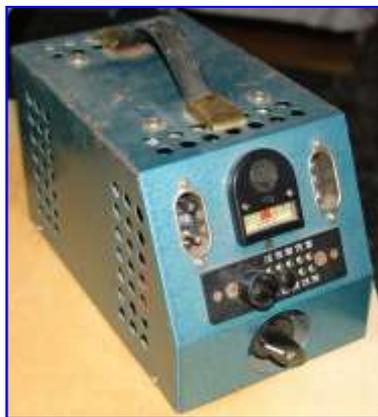
Stabilizzatore di tensione (220/110) per proiettore cinematografico 16 mm
