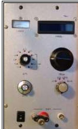
Oscillatore valvolare sinusoidale
