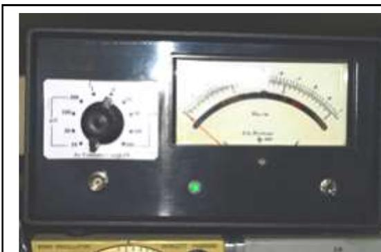
Clone di Voltmetro AC HP 400H 10 mV - 300 Volt
