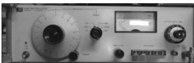
Test Oscillator HP 654 10Hz - 10 MHz calibrato Con attenuatore + 10db -80 db Uscita bilanciata e non.
