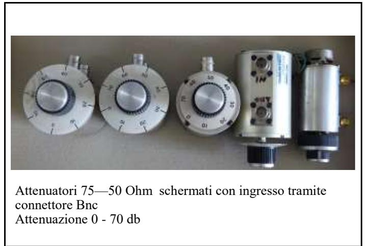
Attenuatori 75—50 Ohm schermati con ingresso tramite
