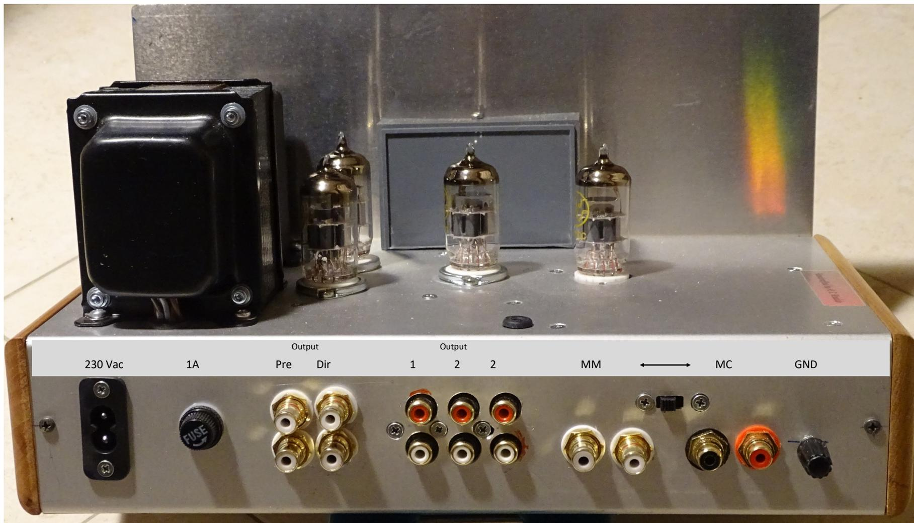
Visione lato superiore sezione preamplificatore. - visibile Alimentatore, valvole e ingressi vari
